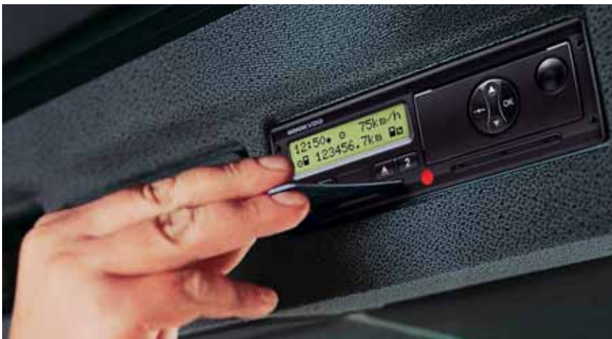
Es braucht die Karte: Der digitale Fahrtenschreiber funktioniert nur mit der Chipkarte.
